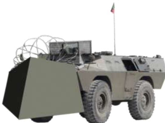
Figura 4-3 – Protótipo da Chaimite V200 para remoção de barricadas
